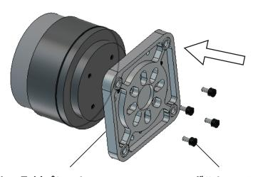
モーター取付プレートは、次項3のアルミフレームへの取付を想定した部材です。本部品を使用せず板金等のその他部品を代用頂く場合、2mm以下の厚さの部品をご使用ください。
